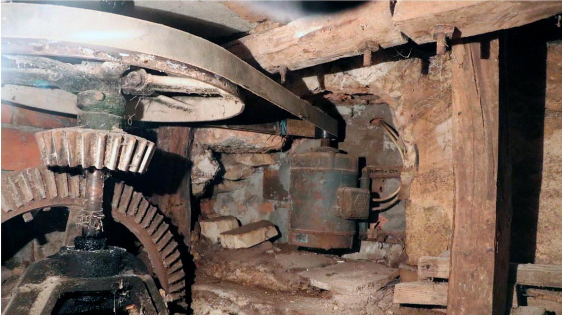
Figura 6 – Entrosga, carroto e motor elétrico adaptado ao mecanismo do moinho ©Memória Imaterial
